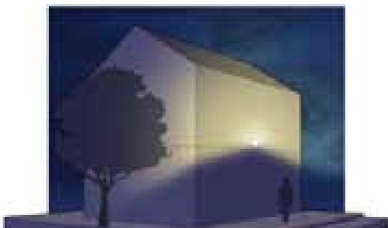
Éclairage très mauvais : une grande partie du flux lumineux est perdue dans le ciel avec pour conséquences un gaspillage d'énergie et une pollution lumineuse très importante.
