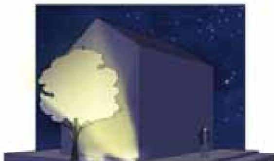
Éclairage très mauvais : le flux est dirigé du bas vers le haut et éblouit la végétation. Il y a une forte nuisance sur la végétation et la faune hébergée ainsi qu'une forte pollution lumineuse.
