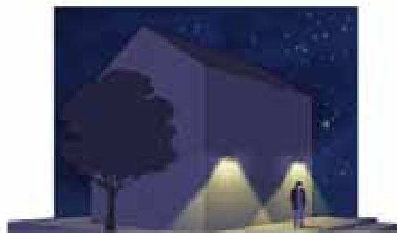
Éclairage bon : le flux est dirigé du bas vers le haut, la végétation n'est pas éblouie et la pollution lumineuse est limitée.
